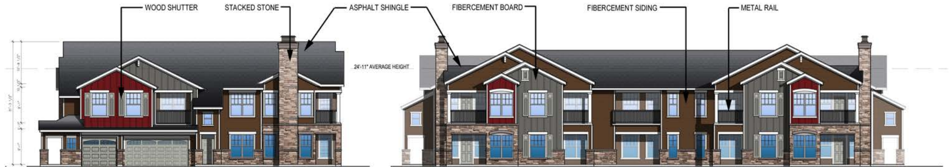
03 ELEVATION 03 - TYPE D SCALE: 1/8"=1'-0"
